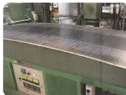
④ アニール 熱収縮を安定させるために、熱や機械的応力のできた歪を除去する
