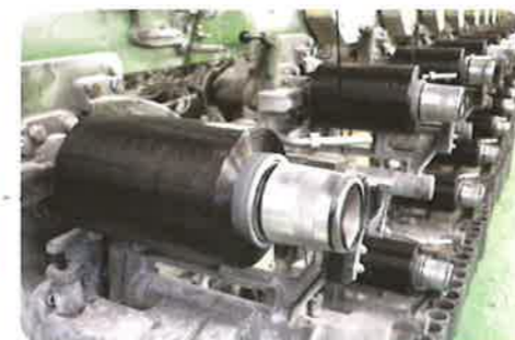
⑤ ワインダー できあがった糸はロール状に巻き取られ、タテ糸やヨコ糸に使用する
