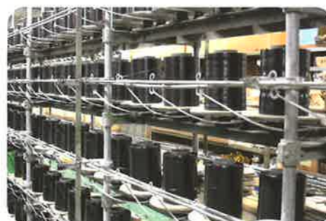
⑥ クリール 約2000本の糸を手作業で置いていく
