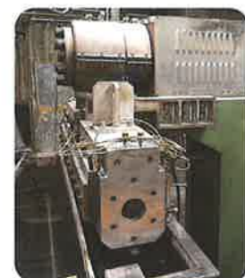
① 押出 熱熔融してフィルム状に押出す (インフレ-Tダイ)
