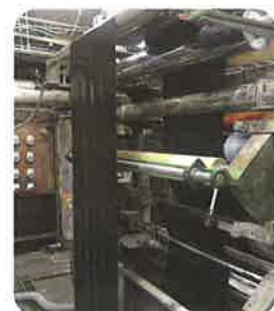
② 冷却 冷却しながらチューブ状、フィルム状に成型する (水冷、空冷)
