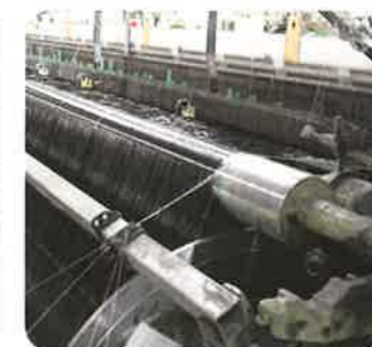
⑨ 製織 ビームに巻かれたタテ糸にヨコ糸を織り込む
