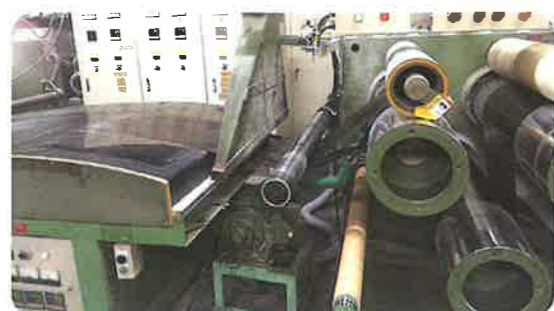
③ 延伸 フィルムをスリットして、決められた幅、厚みになるよう加熱・延伸することで強度を増す (ロール、熱板)
